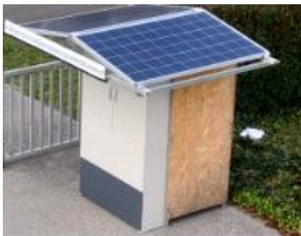
Autonomna stanica za navodnjavanje
